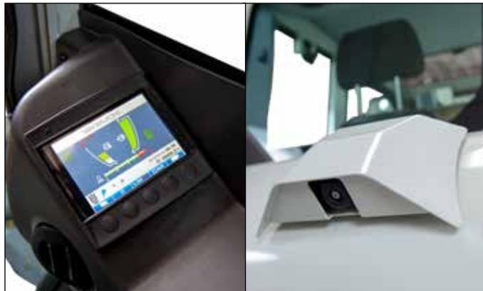
Nuevo display, más resistente a arañazos de cristal laminado antivaho con visualización automática de la cámara de marcha atrás. Menu de taller con nuevas funciones.
