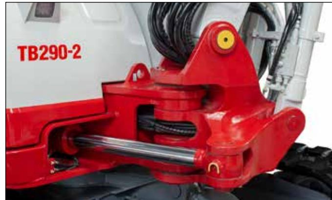
Bloque de giro robusto. Amortiguación final en cilindros de elevación, balancín y giro de brazo. Aviso de sobrecarga y válvula antirretorno.
